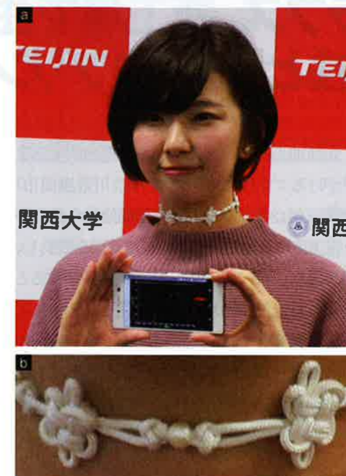
図2 ポリ乳酸の繊維を組みひもにした「圧電組紐」 首に巻かれたチョーカーがウェアラブルセンサーとなっている。脈動を検出してスマートフォンにデータを送信している(a)。チョーカーには飾り結びが施されている(b)。
