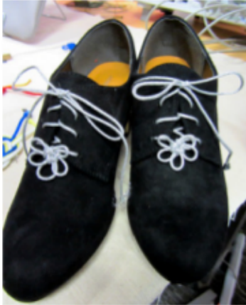
体の動きを感知する「圧電組みひも」を使った靴＝東京都千代田区
