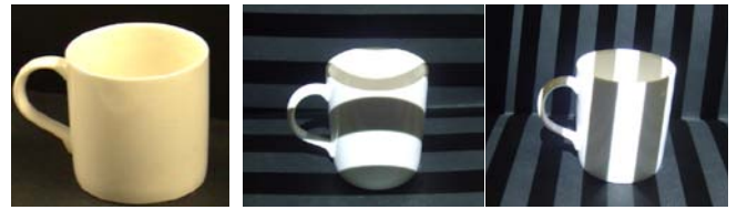
(a) 計測対象 (b) 縦パターン投影 (c) 横パターン投影 プロジェクタには、最大輝度 2500 ルーメン、パネル画素数 1024
