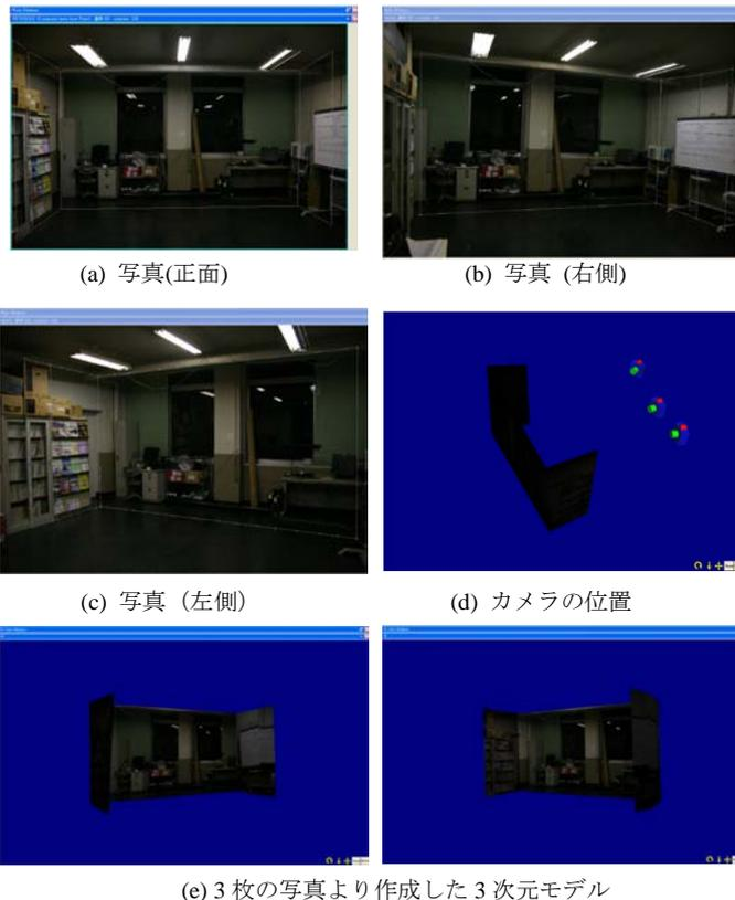
図 2. 写真測量による空間モデリング
